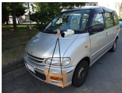
図4. 移動観測に用いた自動車に設置した強制通風式温度測定装置
