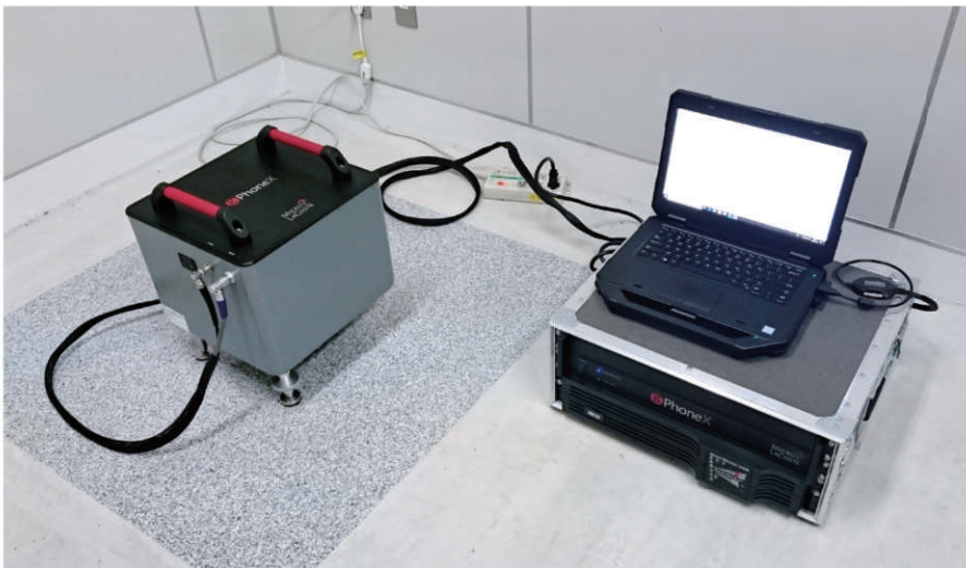
研究所で観測中のgPhone重力計。 左側：重力センサー。右側：電源装置と記録・解析用のPC。
