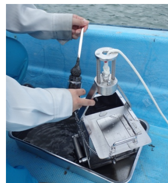
図2 エクマンバージ採泥器 による底質採取の様子
