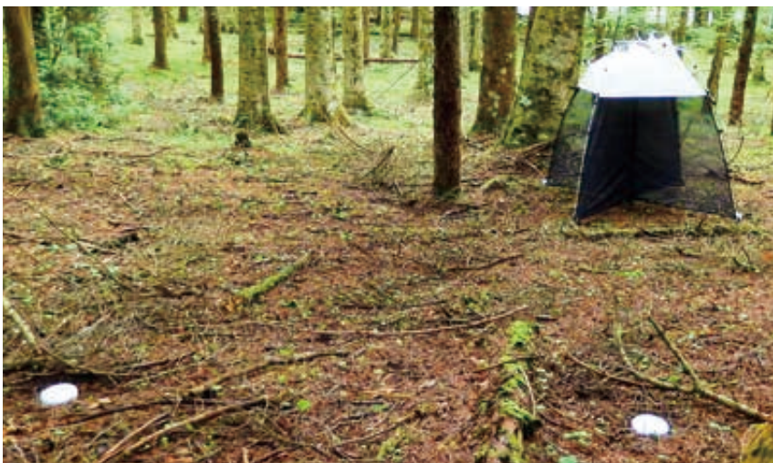
写真1. ピットフォールトラップ (手前の白いもの) とマレーゼトラップ (奥のテント状のもの)。
