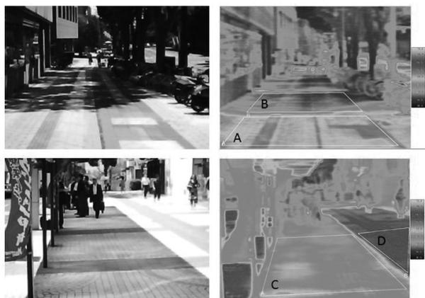
図4 南向き歩道（上）とバスロータリータクシー乗り場（下）の赤外線サーモカメラによる表面温度の分布
