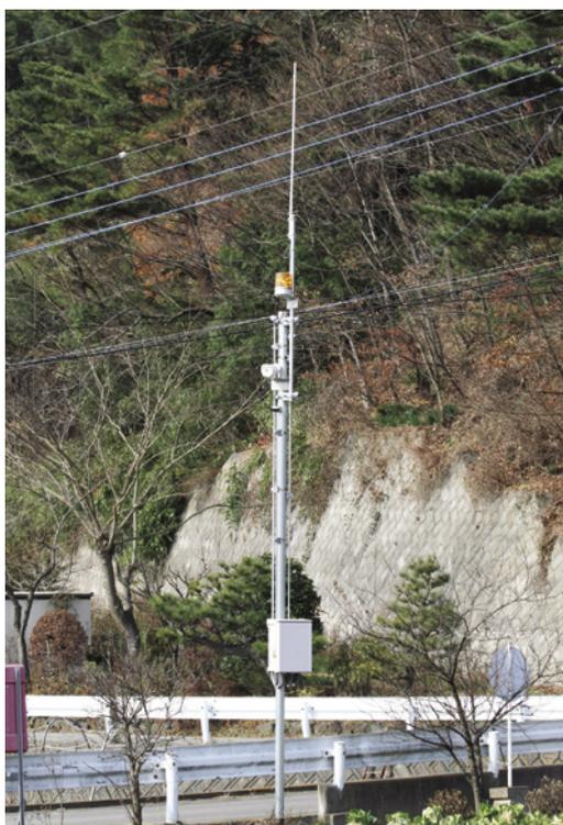
写真 2. 富士吉田市旭地区に設置されたサル自動接近警報システム
