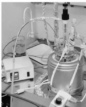
写真1 廃プラ分解装置
