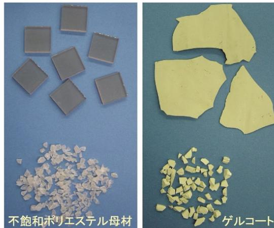
写真2 廃FRPの実験試料
