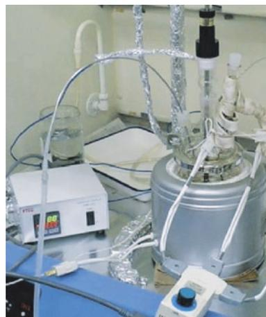
写真1 廃プラ分解装置
