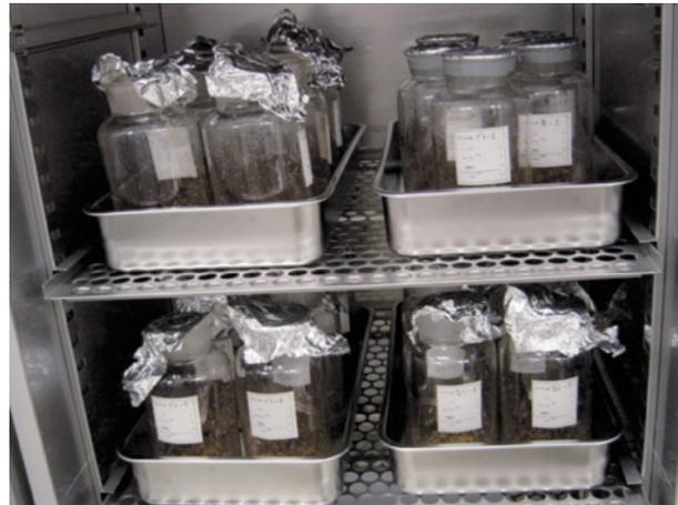
写真1 恒温恒湿槽内で堆肥化中の生ごみ試料
