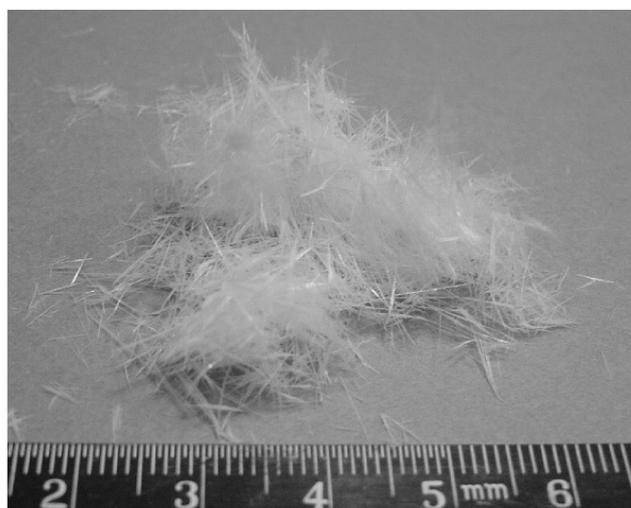
写真3 回収した化学原料（フタル酸）
