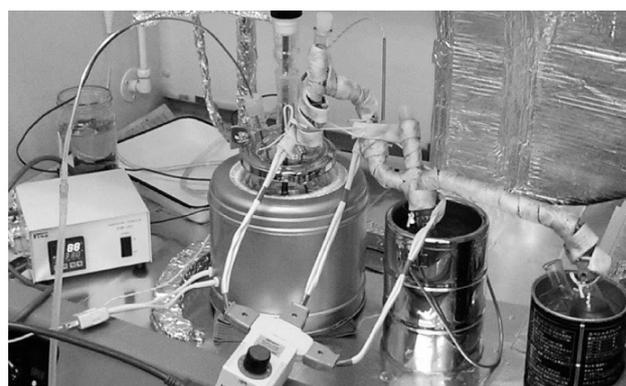
写真 1 廃プラの分解と化学原料の回収装置
