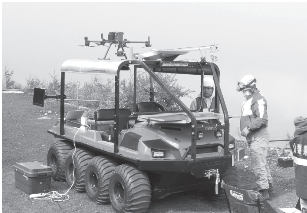
写真2 ローカル 5G 基地局を搭載し周囲の通信ネットワークを確立した上でスターリンクによるインターネット接続を実現した 8 輪バギー車両
