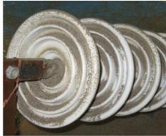
降灰付着直後                      注水FOV試験直後
