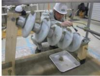
がいし試料への火山灰付着状況      火山灰付着測定状況
