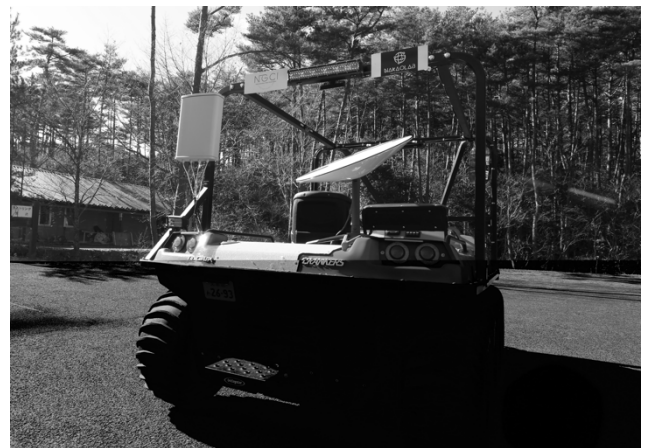
写真2 通信設備のローバー搭載実験 ローカル5G基地局を含む通信設備を、登山道での運用が可能な8輪バギーに搭載する実験の様子。
