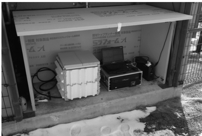
写真 1 SL4ST SL4ST に設置された gPhoneX 重力計。左側のセンサー部は断熱材で保護されている。
