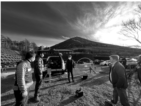
写真1 衛星通信による実験 スバルライン5合目において衛星通信によるインターネット接続でローカル5G基地局を稼働させる実験を行った様子。
