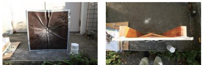
図2 実験後の木造試験体の基本構造部分 (左: 正面、右: 裏面) (巻頭カラー図参照)
