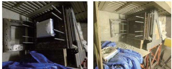
図1 模擬火山岩塊による衝突実験前後の様子 左図実験前、右図実験後。木造試験体の前面に人工軽石 16cm を配置した。(巻頭カラー図参照)
