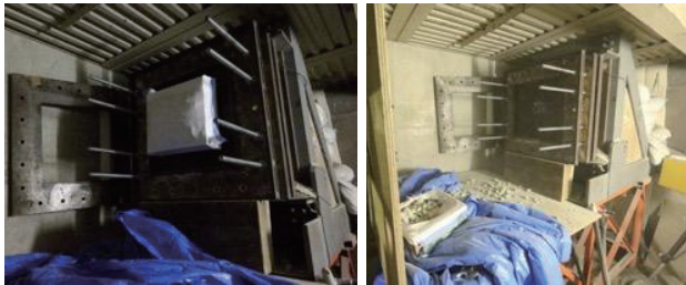
図 1 模擬火山岩塊による衝突実験前後の様子 左図実験前、右図実験後。木造試験体の前面 に人工軽石 16cm を配置した。
