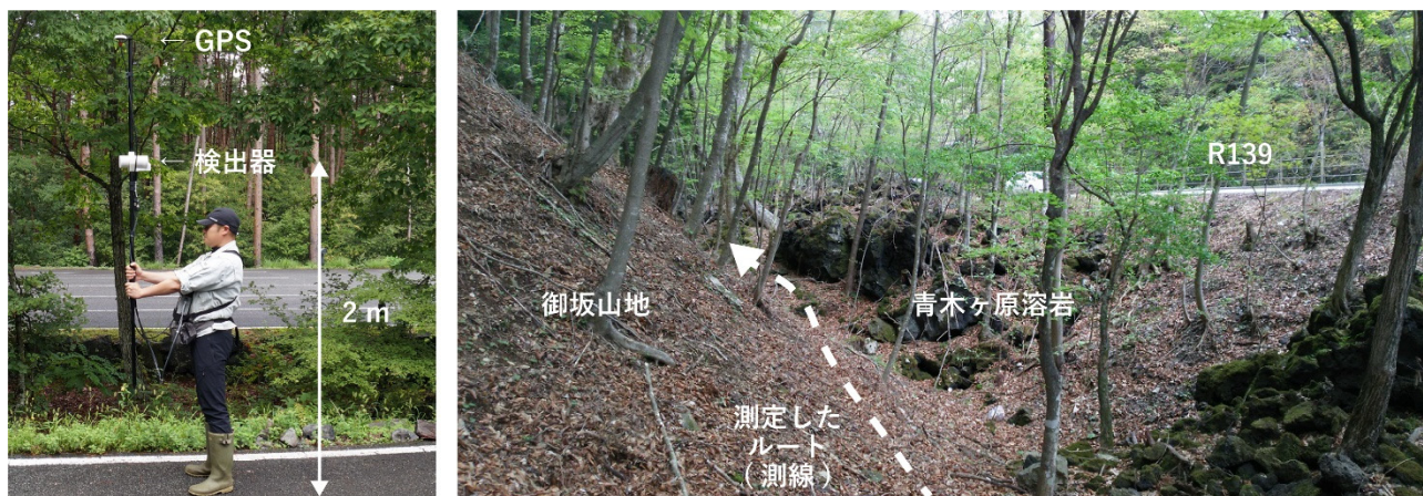
図 12 オーバーハウザー磁力計による地上磁気異常測定
