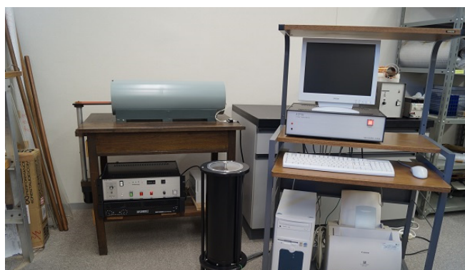
図4 交流消磁装置・スピナー磁力計
