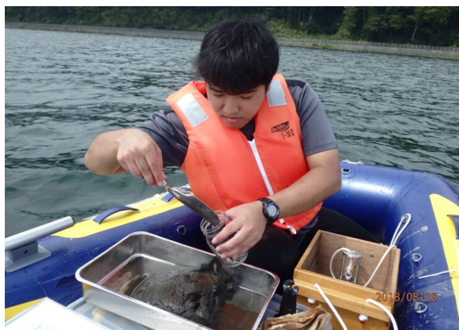
図 4 エクマンバージ採泥器による底質採取の様子
