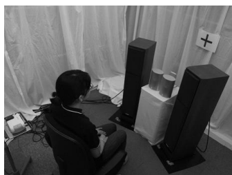
図 II-1 実験室内の様子（上：スピーカーの配置図、下：室内の写真。ビーブ音：サブテーマ 1 において聴覚誘発電位の導出に使用、検査音：サブテーマ 2 において聴力検査に使用。）
