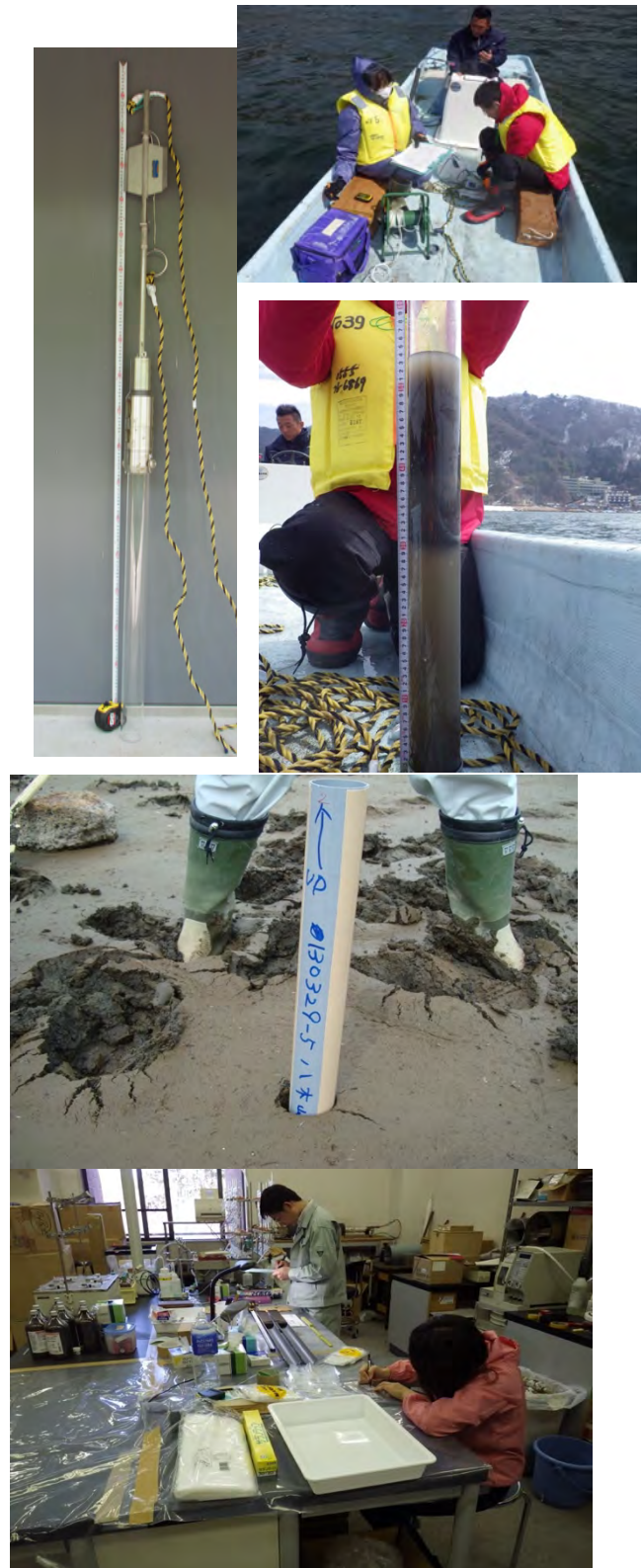
図 II-13 河口湖湖底堆積物 採取・処理状況 写真 左上段 打込式採泥器 右最上段 船上作業 中段上 湖底堆積物採取 中段下 湖岸での堆積物採取状況 最下段 採取したコアの室内処理作業
