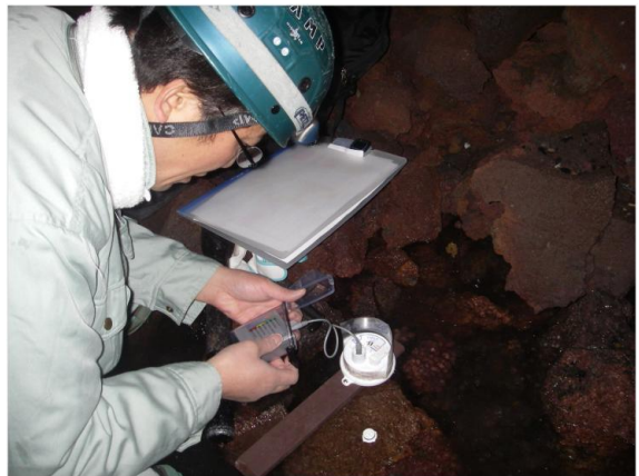
写真 8 データロガーからシャトルでデータを回収する。(2006 年 12 月 25 日 富士風穴第 1) 篠田撮影
