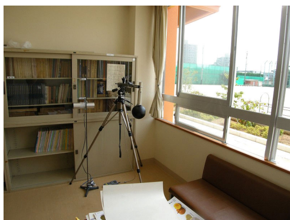
図 2-1 甲府市立真川小学校での温熱環境測定状況と測定装置
