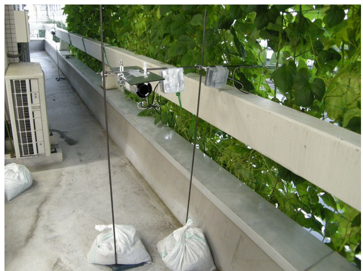
屋外強制通風式温度湿度計
