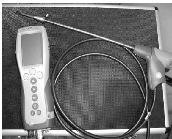
図Ⅱ－１４ 燃焼排ガス分析計（TEST0335）
