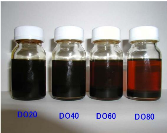
図 I-3 分解油(ウレタン 30wt%: PO_{30} )と軽油を、重量比 8 : 2、6 : 4、4 : 6、または 2 : 8 で混合して作成した燃料
