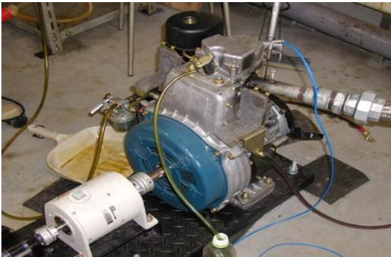
図Ⅱ－１０ 混合燃料を用いた運転実験を行ったディーゼルエンジン (DY41DS)
