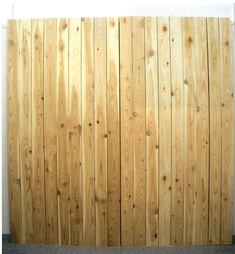
口絵写真3 県産認証カラマツ無垢材を使って作成した木質壁 木質壁は縦 190cm、横 180cm。後ろは実験に用いた白クロス壁。
