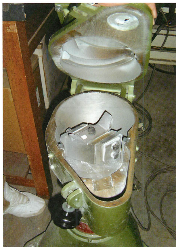
図２－２ 廃プラ用の破碎刃
