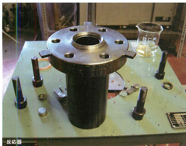
図 2-9 オートクレーブの反応器
