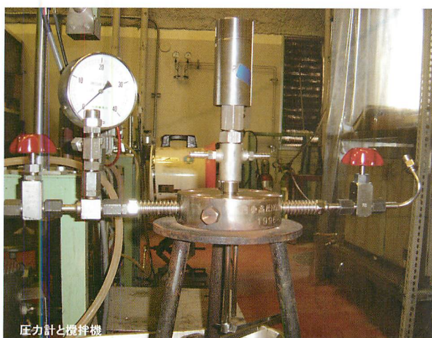
図 2-11 オートクレーブの攪拌装置
