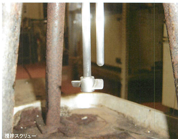
図 2-12 オートクレーブ攪拌スクリュー
