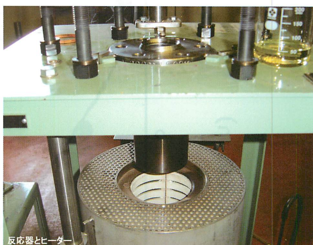
図 2-13 オートクレーブのヒーター
