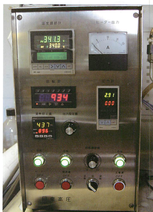
図 2-14 オートクレーブの温度制御器
