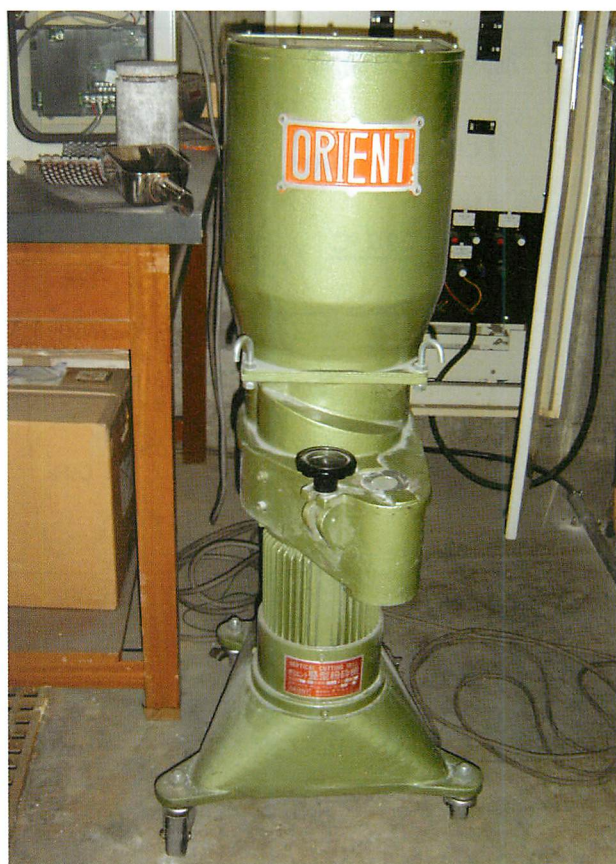
図２－１ 廃棄プラスチックの破碎機
