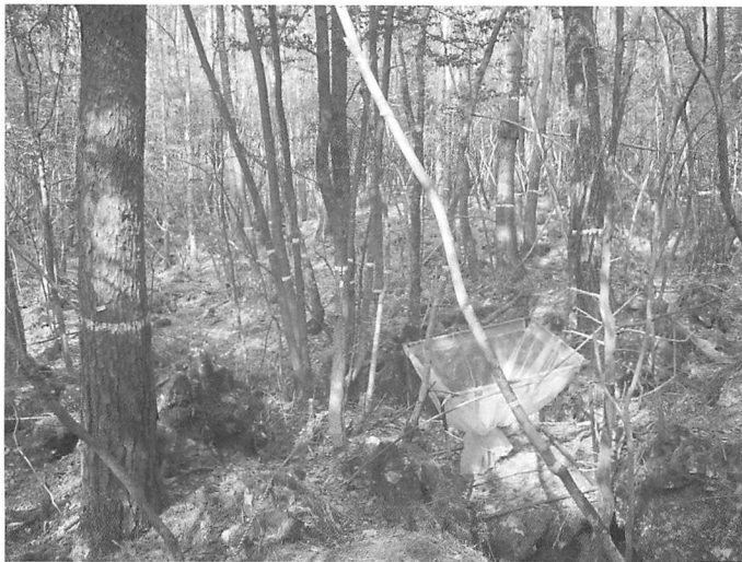
図 2-4 山梨県富士吉田市のタワフラックス観測サイトであるアカマツ二次林内に設置されたリタートラップ 受け口の面積は 1 m 2 であり、筒状のネットの底部を地面に触れないように紐で縛ってある。周辺の樹木には直径の測定位置をペンキでマーキングしてある。
