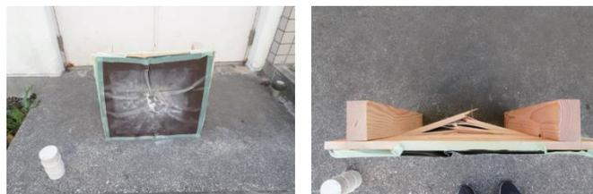
図2 飛翔体速度 44 m/s で 12 cm 厚の軽石を前面に配置した実験結果
