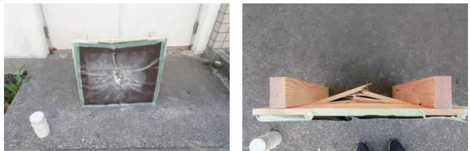
図2 飛翔体速度 44 m/s で 12 cm 厚の軽石を前面に配置した実験結果。左図は正面から見た写真でガルバリウム鋼板が貫通せず変形している。右図は同じ試験体の裏面の様子で木材は破断している。（巻頭カラー図参照）
